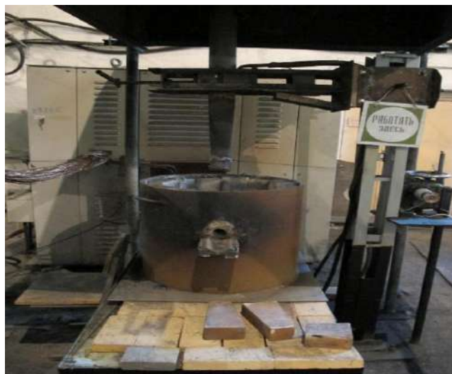
Рисунок 9 – Электродуговая печь 150 кВА
