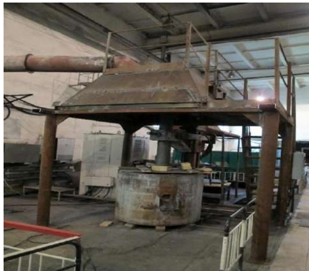
Рисунок 8 – Электродуговая печь 250 кВА
